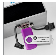
USB 2.0 aansluitmogelijkheden: Voor het gemakkelijk aansluiten van toetsenborden, barcode-scanners en USB-geheugensticks.
