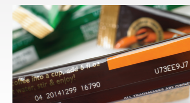
SmartLase C350HD+ 固体饮料应用：咖啡条形包装
